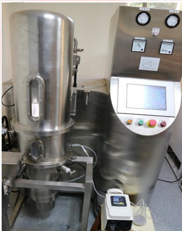
流動層造粒/包衣加工機及不同工法之產品暨其被覆層型態
