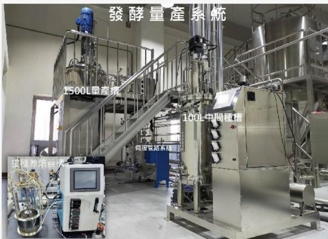
液態發酵量產系統製程設備（左圖）、固態發酵系統製程設備（右圖）
