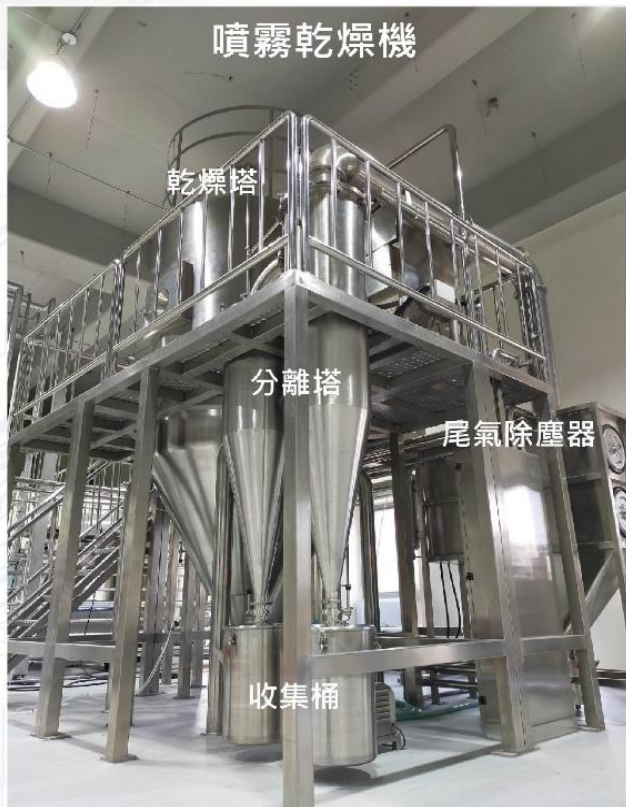
劑型調製設備（噴霧乾燥機、粉碎混和機及流動層包衣造粒機）
