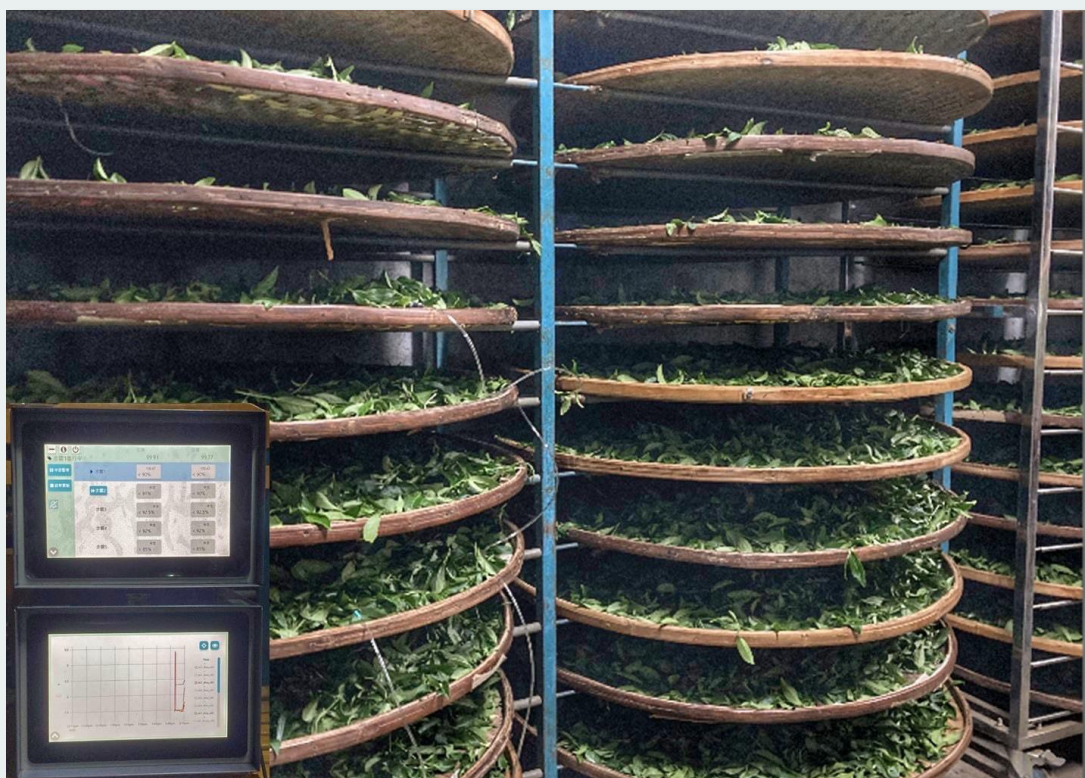
電子鼻實機於茶葉製程中運行狀態
