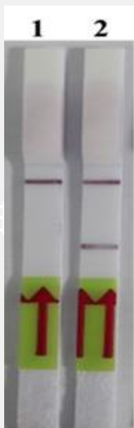
以LAMP結合LFD進行白蝦微孢子蟲病原(EHP)檢測果。
