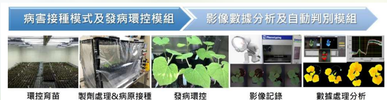
半自動化病原接種暨防治資材施用模組與表型自動化判別模組
