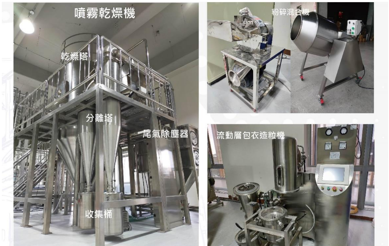
圖3、劑型調製設備(噴霧乾燥機、粉碎混和機及流動層包衣造粒機)
