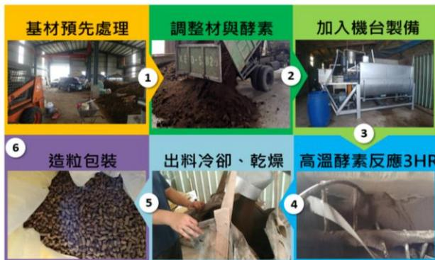
群耕採用酵素取代微生物進行禽畜廢棄物的分解，藉助蛋白酶、脂解酶、纖維素酶...等的作用，僅耗時3-4小時即可將有機質轉化為腐熟完備的有機質肥料，處理速度較傳統堆肥更加迅速。機械設備採節能式設計，槽體加溫過程迅速，內部保溫恆定，攪拌均勻且無死角，讓產物品質穩定
